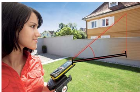
Le distanze orizzontali possono essere misurate nonostante la presenza di ostacoli grazie al sensore di inclinazione.
